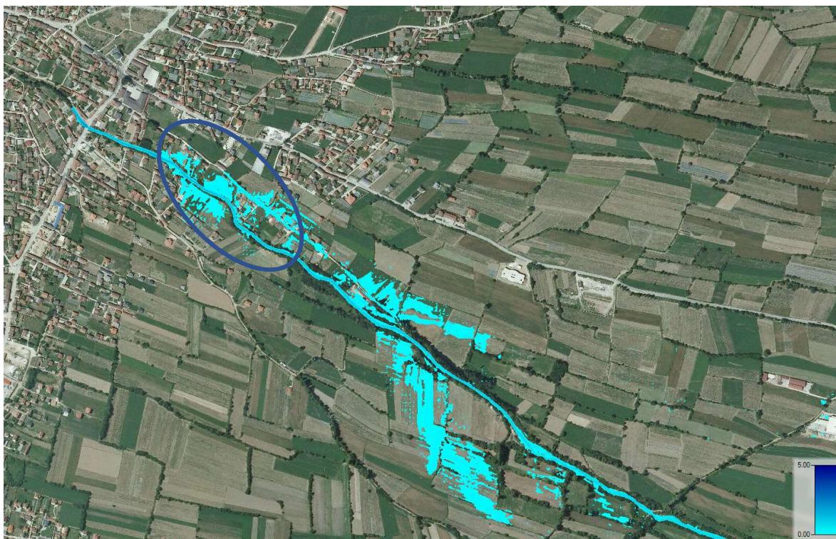
Слика 49 Слободна водна површина при Q = 25 \text{ m}^3/\text{s}
