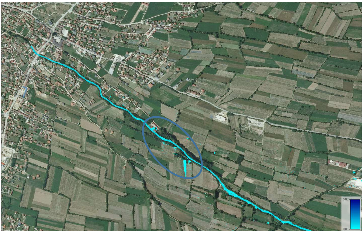
Слика 48 Слободна водна површина при Q = 12 \text{ m}^3/\text{s}
