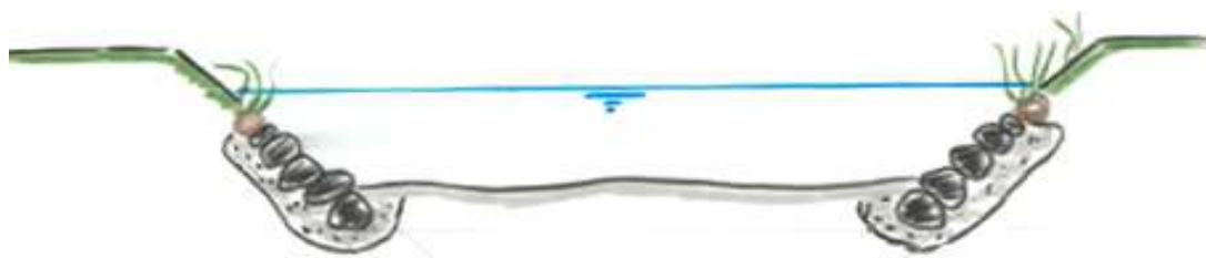
Слика 30 – Обезбедување на косината со реден крупен камен и хидрофилна вегетација
